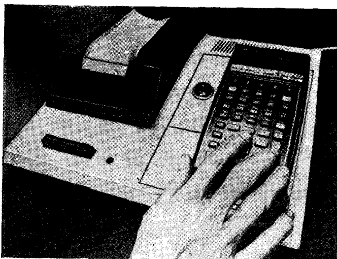
Рис. 22.32. Термическое построчно печатающее устройство программируемого калькулятора.
