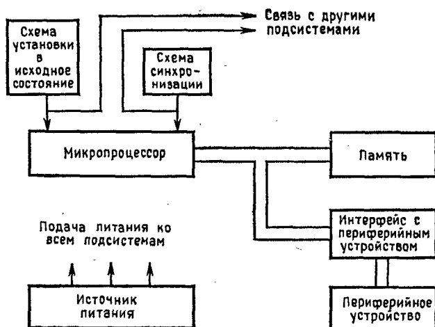
Рис. 25.1. Компоненты микроЭВМ.
