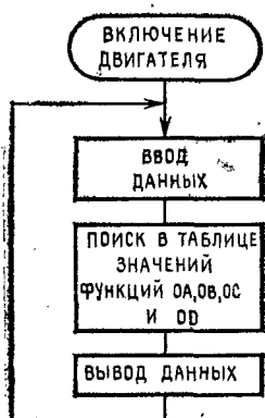
Рис. 25.32. Схема программы контроллера с реализацией поиска по таблице.
