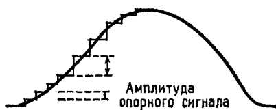
Рис. 30.4. Линейная экстраполяция с изменяемым опорным напряжением.
